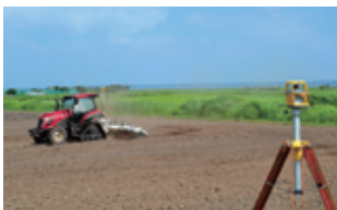
YT4104A × レーザーレベラー作業
